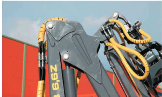
Achten Sie darauf, dass sich die Schließhaken des Teleskoparms in der Halterung des Hubarms befinden.
