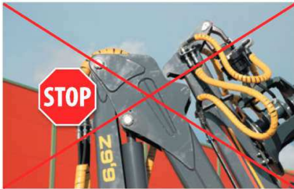
Achten Sie darauf, dass sich die Schließhaken des Teleskoparms in der Halterung des Hubarms befinden.
