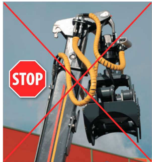
Achten Sie darauf, dass der Verschluss für den Greifer/die Schaufel am Hubarm eingerastet ist.
