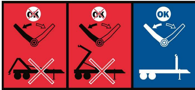
Figur 24. Användande av växlingsenheten
