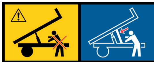
Bruk av sikrings søylen
