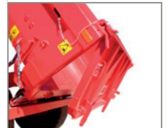
Mechanisch hebbare Heckklappe (nur für BT-8)
